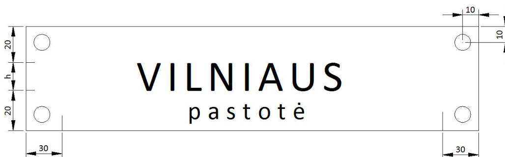
1 pav. 110-400 kV transformatorių pastočių pavadinimo lentelė
